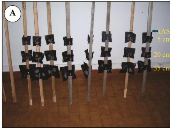
Figura 1. Detalle del experimento. A , Estacas con las bolsas adheridas a las distintas profundidades, (IAS = Interfase agua-sedimento). B , Estacas enterradas en el sitio de muestreo al inicio del experimento en diciembre del 2010. C , Detalle de la bolsa utilizada y de los ejemplares de Heleobia parchappii y Biomphalaria peregrina . D , Ejemplar de Pomacea canaliculata donde se puede apreciar la diferencia de tamaño con respecto a las otras dos especies H. parchappii y B. peregrina .
